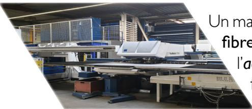
Un magasin automatique alimente notre parc de marque **TRUMPF**, constitué d'un **laser-fibre**, d'un combiné **laser-poinçonnage** et d'une **poinçonneuse**. Nous découpons l'**acier**, l'**inox**, l'**aluminium**, le **cuivre** et le **laiton** et pouvons poinçonner le **PVC**. Notre format maximal est 1500x3000mm.
