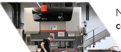
Nos équipements de pliage, de marques **TRUMPF** et **BYSTRONIC**, sont équipés d'un **contrôleur d'angle** et de **butées 6 axes**, permettant des pliages en diagonale ou du bombage. Ils permettent de plier des pièces jusqu'à 3 mètres de longueur.
