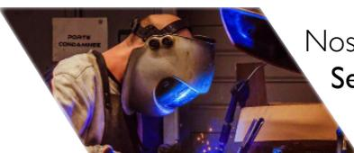
Nos équipements de soudage nous permettent de travailler l'**acier**, l'**alu** et l'**inox** en soudure **Semi et TIG**, en soudure **par points** et en soudure **pistolet**. Nous sommes également équipés pour souder par points le **cuivre** et le **laiton** et passer les pièces en **inox**.
